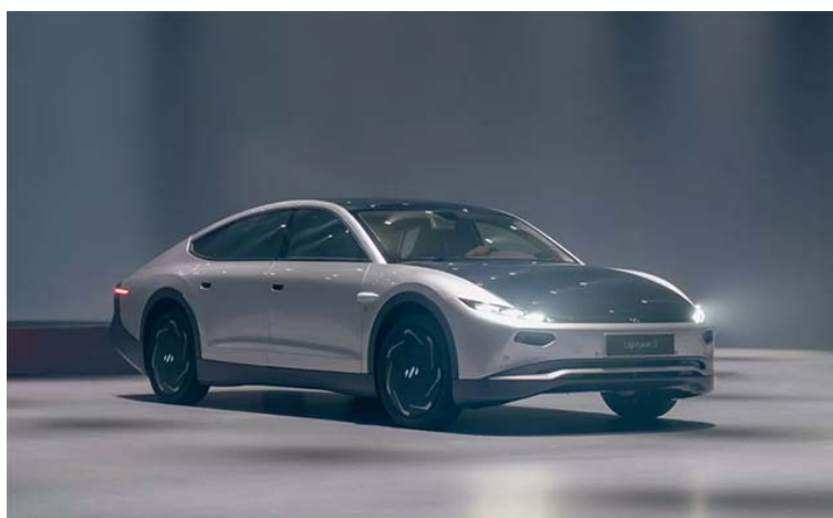
図 6. 2. 22 Lightyear 0 のルーフとフードにはソーラーパネルがある
