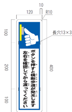
図 5.5 押ボタン用表示板
