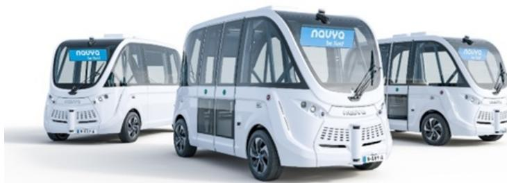
図 6.6 GAUSSIN MACNICA MOBILITY の自動運転 EV バス (NAVYA ARMA)
