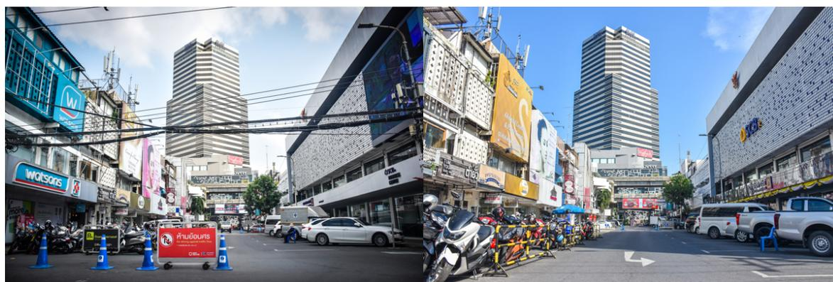
図 3.11 サイアム・スクエア 電線地中化前（左）と後（右）<sup>3</sup>
