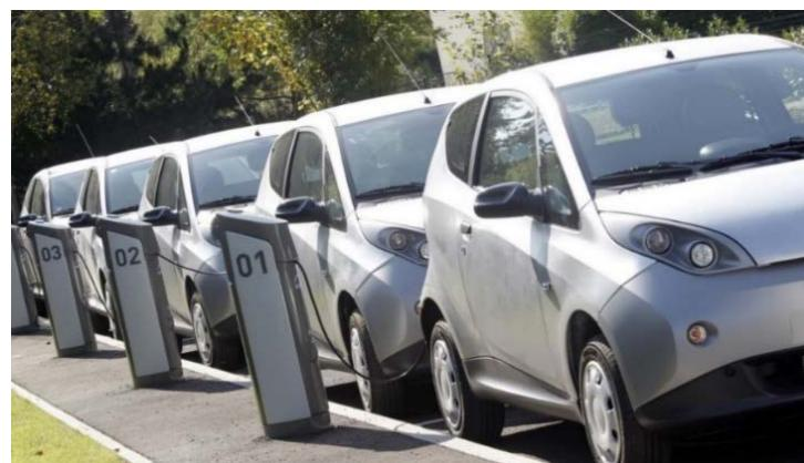
図 1.8 AutoLib の車両と充電装置
