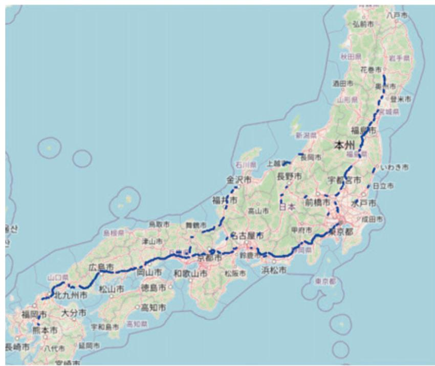
図 5.3 給電レーン最適配置結果（n=320 の場合）
