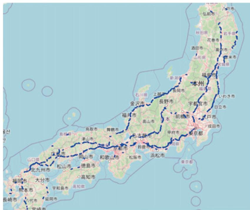
図 5.6 給電レーン最適配置結果（n=640 の場合）
