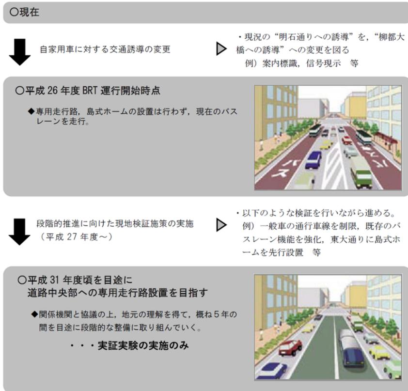
図 3.14 新潟市 BRT (萬代ライン) 専用走行空間の構想 <sup>23)</sup>
