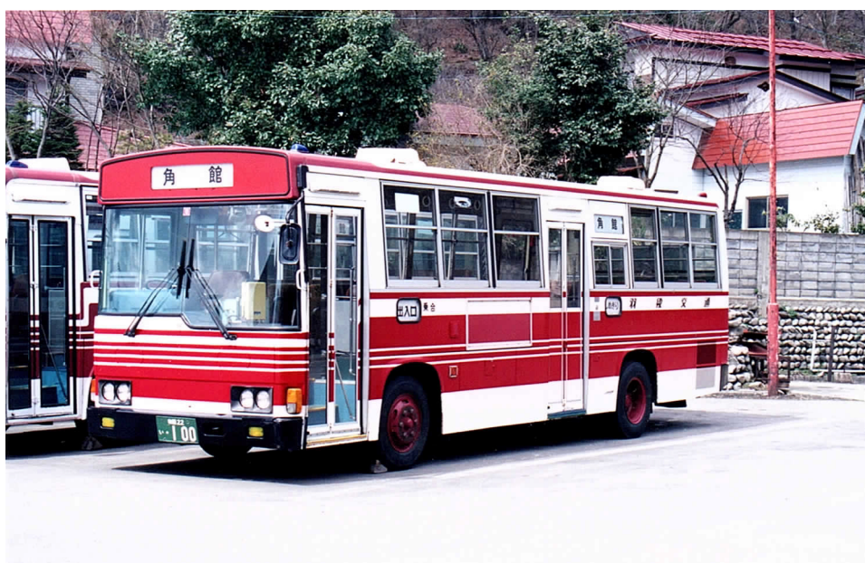
写真 6.3 後ろドアを閉め切って前乗り前降り整理券方式のバス (羽後交通、2004年頃、この乗降方式は近年少なくなった)
