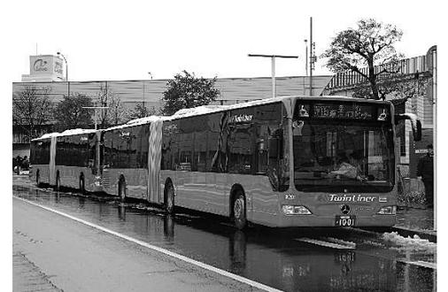
車体幅 2.5m 超の車両を特例で運行。
