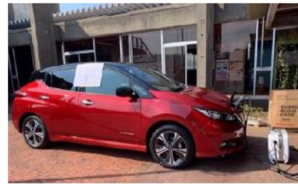
EVからの給電：避難所等で携帯電話充電、扇風機、冷蔵庫等に使用
