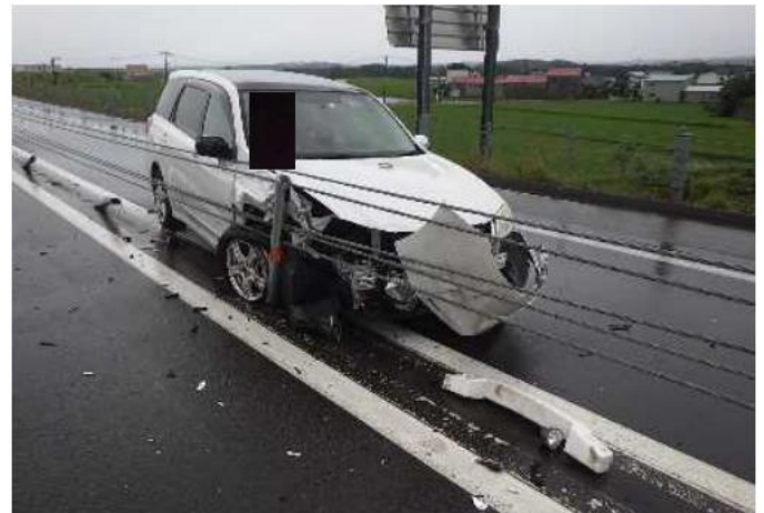
ワイヤーロープ接触事故の状況
