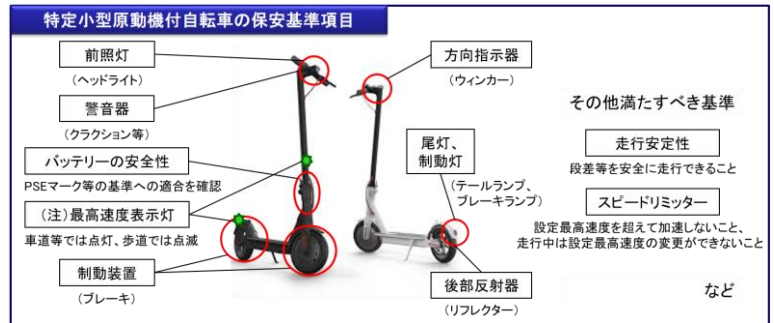
図4 特定原動機付自転車（電動キックボード）の車両基準
